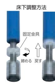
固定金具をゆるめ、任意の高さに調節後、固定金具を支柱側に戻すことでしっかりと固定できます。
